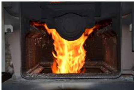
Obr. č. 13 Optimální tvar plamene
